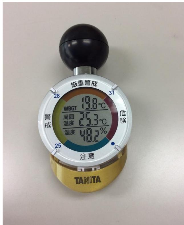
WBGT は、気温(乾球温度)、湿度(湿球温度)、輻射熱(黒球温度)の 3 要素から算出されますが、湿球温度と黒球温度には気流の影響も反映されるので、WBGT は 4 要素すべてを取り入れた指標と言えます。
